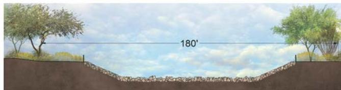
**RECOMMENDED SOLUTION & ALTERNATIVE B: GROUTED ROCK CHANNEL**
