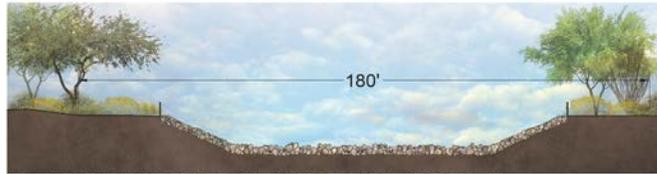
**RECOMMENDED SOLUTION & ALTERNATIVE B: GROUTED ROCK CHANNEL**
